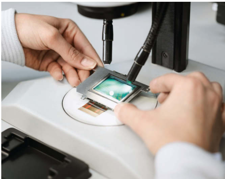
La couche de protection endommagée du verre du filtre IR peut entraîner des effets de corrosion.
