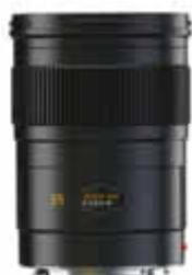
Lichtstarkes Weitwinkel-Objektiv, vor allem geeignet für den Einsatz in Innenräumen oder für Architekturaufnahmen. Es nutzt zwei asphärische Linsenoberflächen und Sondergläser mit anomaler Teildispersion oder hoher Lichtbrechung sowie eine Hintergruppenfokussierung für höchste Leistungen bis in den Nahbereich.
