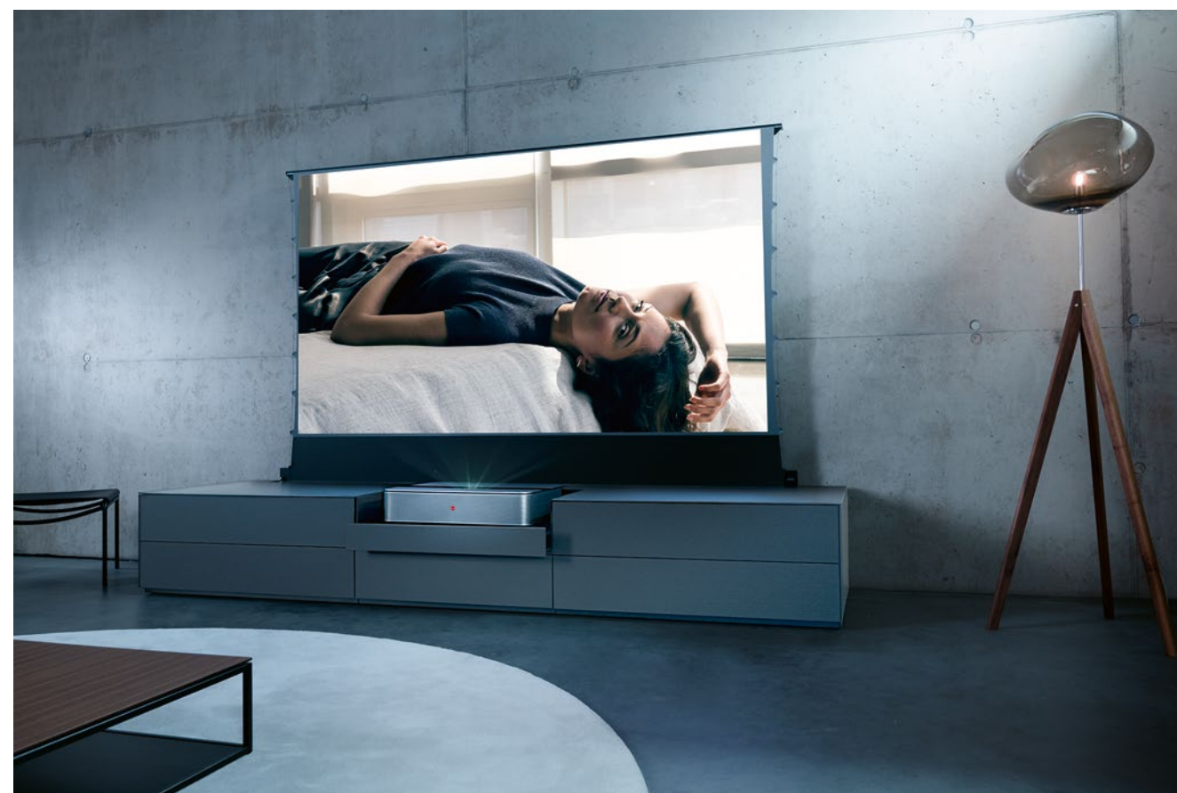
DER LEICA CINE 1 DARF AUFGRUND DER SPEZIELLEN SHORT-THROW-KONSTRUKTION PRAKTISCH DIREKT VOR DER LEINWAND STEHEN.
